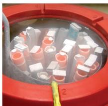
I film per etichettatura criogenica Lintec Europe sono adatti alla immersione diretta in azoto liquido a -196°C, e offrono una maggiore adesione per resistere a questo shock termico, impedendo il distacco dell'etichetta.
