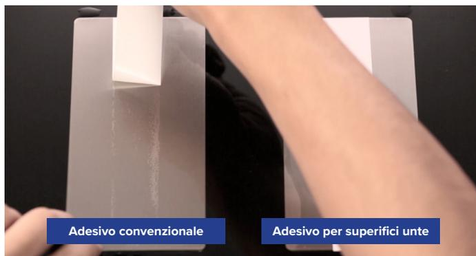
**Adesivo convenzionale:** quando viene rimosso il materiale mostra un'adesione molto bassa; l'adesivo si trova sulla parte superiore dell'olio e non aderisce alla piastra di prova in metallo.
